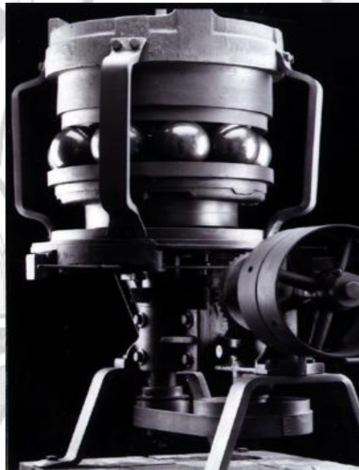
Macchina per rettifica delle sfere progettata da Friedrich Fischer nel 1883.
